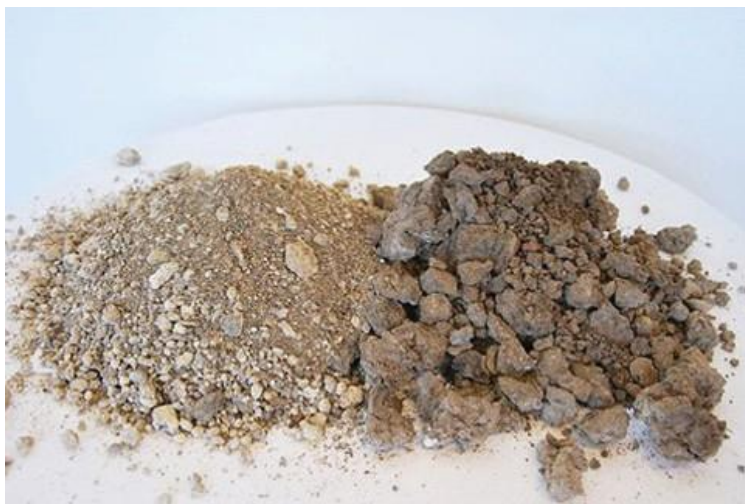
Maan rakenne jälkeen ja ennen rakennekalkitusta. Kuva: Nordkalk
